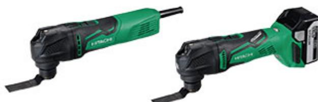
Le Multi-Tool Hitachi est disponible en version filaire de 350 watts et en version brushless sur batterie 5 Ah. Ces deux appareils ont une oscillation totale de 3,2° et acceptent 12 positions d'outils sur 360° (changement d'accessoire sans outil). Ils ont des vitesses variables réglables sur cinq positions et un mode vitesses automatiques.
