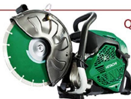
La découpeuse thermique pour le béton CM 75EAP, à disque de 300 mm de diamètre, est équipée d'un moteur de 75 cm<sup>3</sup> délivrant une puissance de 3 900 watts. Elle est dotée d'un décompresseur intégré (démarrage facile), d'un système antivibration par ressort hélicoïdal et d'un procédé d'échappement à impulsion qui augmente la puissance et réduit les émissions. Cette machine est déclinée dans un modèle supérieur avec disque de 350 mm de diamètre.
