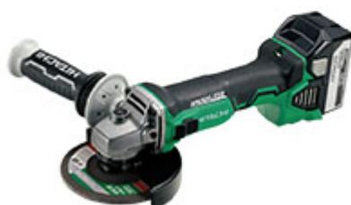
La meuleuse 125 mm à moteur brushless G 18DBL 5A, sur batterie lithium-ion 5 Ah, se distingue par sa compacité, 326 mm de longueur pour un corps de 152 mm de diamètre parfaitement maniable d'une main. Elle intègre le démarrage progressif et les protections anti-redémarrage et anti-recul.
