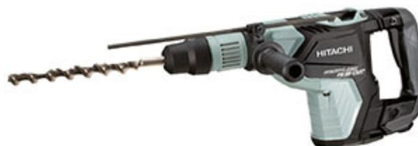
Le perfo-burineur SDS-max 40 mm à moteur brushless DH 40MEY développe une puissance de 1 150 watts et une force de frappe de 11 J pour un poids de 6,8 kg. Il possède quatre vitesses de rotation (250 à 500 tr/min), quatre cadences de frappes (1 430 à 2 850 cps/min) et bénéficie de la technologie antivibration UVP qui amène son taux de vibration à 7,3 m/s<sup>2</sup>. A noter la couleur vert pôle de son carter aluminium, également repris sur ses les deux modèles supérieurs en 45 et 52 mm.
