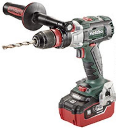
Parmi les dernières nouveautés Metabo, La perceuse à percussion à moteur brushless et mandrin **Quick SB 18 LTX BL Q I** permet de percer dans le bois jusqu'à 65 mm, dans l'acier jusqu'à 13 mm et dans la maçonnerie jusqu'à 16 mm. Elle est dotée de deux vitesses de rotation jusqu'à 600 et 2 050 tr/min et atteint un couple de 120 Nm pour le vissage dans les matériaux durs. Elle est livrée avec deux batteries LIHD de 18 V 5,5 Ah.
