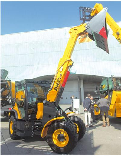
Le Pivot T40 de Dieci est une chargeuse articulée compacte (5 t, largeur 1,68 m) avec un bras télescopique, pour un déversement facile, dans un camion par exemple. Comme les autres modèles de cette gamme, elle possède une articulation avec deux points de pivots entourant et protégeant l'arbre de transmission, l'oscillation étant placée sur l'essieu arrière pour augmenter la stabilité de la machine. Sa capacité maximale est de 1 800 kg à 3,07 m (1 250 kg à 4 m).
