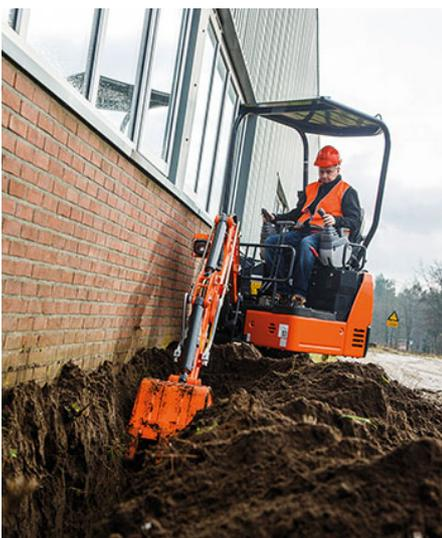
La mini pelle Hitachi ZX17U-5 à rayon de rotation court est destinée aux espaces réduits et confinés avec des trains à chenilles de 980 mm pouvant être élargis à 1 280 mm pour une meilleure stabilité. Elle a une portée de fouille au sol de 3,72, une profondeur de fouille de 2,19 m
