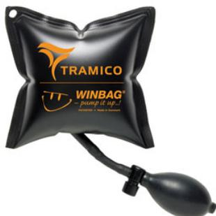
Accessoire d'application, le winbag est une cale gonflable conçue pour faciliter la mise en place de menuiseries. Fabriqué dans une toile enduite renforcée de fibre, le winbag possède une force portante de 100 kg et peut combler des joints faisant de 2 à 50 mm d'épaisseur, ce qui permet à un monteur de stabiliser un châssis de menuiserie et d'avoir les mains libres pour finaliser sans aide son installation dans les meilleures conditions. Le winbag est livré par lots de quatre pièces.
