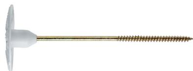
Pour la fixation de tous types d'isolants sur des structures bois comme dans le cadre de construction MOB, Spit propose la cheville Isowood. Elle est équipée d'une vis bois permettant de fixer jusqu'à 200 mm d'épaisseur et d'une rondelle de 90 ou 140 mm de diamètres. La tête de 60 mm de diamètre incorpore un capuchon qui évite les micro-ponts thermiques.
