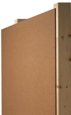
Le Pavaplan est un panneau en fibres de bois préconisé en contreventement intérieur. Spécialement étudié pour travailler sous contrainte élevée en utilisation humide de classe 1 et 2 selon la norme EN 622-2 et le marquage CE HB.HLA2, il assure le contreventement des constructions en ossature bois quelle que soit la finition appliquée (crépi ou bardage). Etanché grâce au Pavafix 60, il répond aux exigences élevées d'étanchéité à l'air de la RT 2012 et du DTU 31-2.
