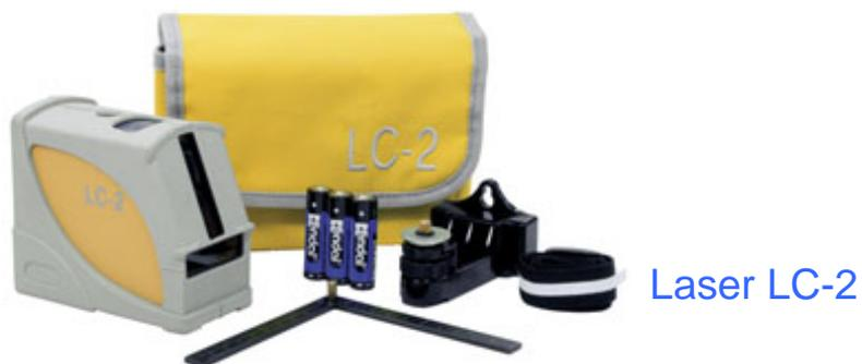
Le LC-2 de la marque Topcon est un laser avec faisceau vertical et horizontal qui dispose du mode pentes ainsi que de la fonction angle droit. Idéal pour les travaux d'intérieur, il s'adapte également aux conditions en extérieur grâce à la cellule de réception LVH-800 (en option) qui lui permet d'atteindre jusqu'à 50 mètres de distance. Il est fourni avec un support mural, trois piles et une sacoche de transport.
