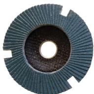
Grand Angle est un autre disque à lamelles de diamètre 125, mais à grains en zirconium. Il présente la caractéristique de posséder en périphérie trois ouvertures à 120° permettant à l'opérateur de voir la pièce usinée en cours de travail.
