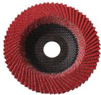
Xtrem est un disque à grains céramique sur toile souple dont les lamelles longues confèrent une souplesse accrue au disque appréciable dans certaines opérations comme l'arasage d'un cordon de soudure. Ce disque proposé en diamètre 125 permet un travail sans échauffement qui allonge la durée de vie du produit.
