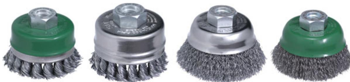
*Préconisées pour éliminer scories, rouille, peinture, profondes incrustations, les brosses TU71 à mèches torsadées acier, inox (coupe verte) ou laiton (jaune) pour meuleuses d'angle sont particulièrement robustes et agressives. SIT maîtrise également parfaitement la technologie des brosses avec fils ondulés.*
