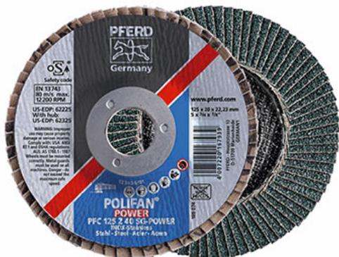
Autre innovation, le Polifon Z-SG Power est un disque à lamelles dont Pferd évolue à 236% le gain en rendement par rapport à la génération précédente ZG Zirkon. Cette performance relève de plusieurs facteurs tels la nature des grains utilisés, sa compacité renforcée, le nombre de lamelles accru, la nature du support. Il est décliné dans les diamètres 115, 125, 150 et 180 dans les grains 40 et 60.
