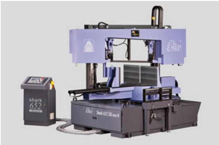
Remo propose la scie électro-hydraulique
