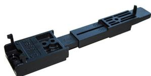
Convenant à tous les types de platelages bois, le clip invisible FTA-IPW / IPA permet une fixation invisible des lames de terrasse. Facile à installer, cet accessoire qui prend en compte les gonflements et retraites du bois, doté d'ergots espaceurs, supprime le recours à des vis apparentes peu esthétiques. Réglable de 120 à 150 mm, ce clip à écartement automatique de lames ventile la terrasse grâce à son effet rehausseur (il est proposé sous forme de kit de 50 clips réglables avec les vis inox).
