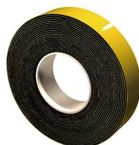
La Bande adhésive FTA-RT permet quant à elle de protéger la face supérieure des lambourdes, l'eau s'évaporant difficilement aux points de contact entre les lambourdes et les lames de bois. Cette bande de 1 mm d'épaisseur et 80 mm de largeur résistante au déchirement, aux UV et à l'ozone, se pose facilement sans outil.
