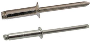
Les rivets aveugles Acton sont disponibles en version inox/inox, alu/inox, en tête plate, en tête fraisée, en diamètre 3, 3.2, 4, 4.8 et 5 mm, et en longueur de 6 à 30 mm suivant la matière. Ils offrent une grande résistance à la traction et au cisaillement.
