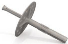
Autre cheville d'isolation à frapper SDR fixations, le modèle CI pour plaques isolantes est destinée à la fixation d'isolants rigides et souples résistant à une compression légère. Elle est pourvue d'une rondelle de diamètre extérieur de 60 mm pour soutenir l'isolant et d'un clou central d'expansion en polyamide plus fibre de verre pour l'ancrage. Cette cheville de diamètre 10 est disponible dans les longueurs 70 à 200 mm.
