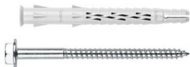
La T-Nux d'Index est une cheville universelle en nylon pour la fixation des charges lourdes dans tous types de matériaux pleins ou creux. Détentricée d'un ATE 13/0754, facile à poser, parfaitement sûre et réversible, cette cheville équipée d'ailettes anti-rotation est pré-montée avec une vis en acier zingué ou en inox Aa4 à tête fraisée ou hexagonale. La T-Nux est disponible en diverses dimensions du diamètre 8 mm et longueur 80 mm jusqu'au diamètre 10 mm et longueur 230 mm.
