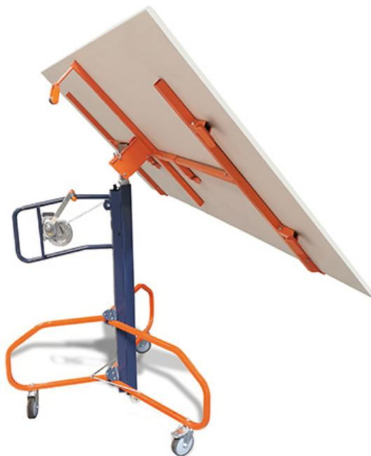
Il complète dans la gamme le lève-plaque Edmaplac 450 muni d'un système à crémaillère pouvant être assisté par une visseuse, pour une grande précision et en tout confort. Pouvant aller jusqu'à 4,50 m de haut (avec rallonge), ce dernier peut soulever une charge maximale de 80 kg. Il dispose également d'un système de frein à deux manettes et d'une plate-forme en bois.
