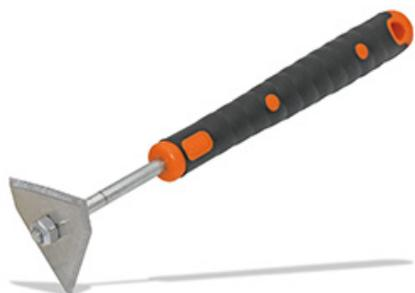
Le grattoir triangulaire permet de creuser et d'élargir les fissures avant de les reboucher. Sa lame triangulaire en inox d'une épaisseur de 3 mm et son manche long utilisable à deux mains facilitent l'utilisation de cet outil dans les zones difficiles d'accès.
