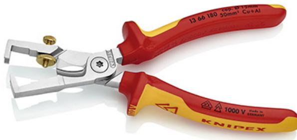
La coupe franche et sans écrasement de câbles en cuivre et en aluminium jusqu'à 15 mm (5 x 2,5 mm<sup>2</sup>) est quant à elle réalisée en partie basse de la tête de l'outil grâce à des tranchants à affûtage de précision, trempés par induction. Longue de 180 mm et pesant 210 grammes, la pince Strix existe en version isolée (certifiée VDE) ou non isolée.
