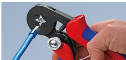
Knipex lance une pince pour le sertissage des embouts de câbles
