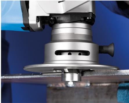
Pferd, le spécialiste allemand des outils d'usinage de surfaces et de tronçonnage des matériaux étend à de nouvelles versions son système Edge Finish (composé d'une meuleuse plus des outils de coupe) dédié à l'usinage des arêtes sur des pièces de moyennes à grandes tailles, disponible jusqu'à maintenant uniquement en version Steel (pour l'acier).
