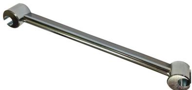
Virutex propose un bras en acier résistant équipé à chaque extrémité d'un support ajouré permettant de redresser ou d'aligner les paumelles de diamètres 16 et 18 mm sur tout cadre ou porte de quelque matière que ce soit. La longueur de cet outil est de 330 mm et son poids de 700 grammes.
