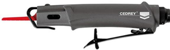
La scie-lime UT8921 de Cedrey est un outil pneumatique alliant puissance élevée et ergonomie d'usage. Polyvalent, cet appareil permet de couper des tôles d'acier de 3 mm d'épaisseur et est pourvu d'un mandrin doté d'une encoche ronde servant à l'attache de limes à queue de 6 mm de diamètre. Pour un confort d'utilisation et une précision supérieures, il peut être équipé d'un raccord tournant gros débit (HO1414).
