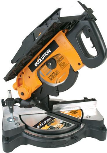
Evolution Rage 6 d'Evolution Power Tools est une scie à onglet multi-usages équipée d'un moteur de 1 600 watts (vitesse à vide de 2 500 tr/min) qui coupe avec précision l'acier, l'aluminium, le bois (même percé de clous) et le plastique avec sa lame 255 TCT (diamètre de 255 mm) à 28 dents (2 mm d'épaisseur) au carbure de tungstène.
