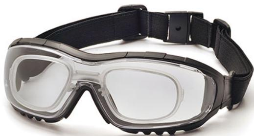
Les lunettes Pyramex V3G commercialisées par Difac sous la réf. EGB821OSTRX sont équipées d'une monture noire en nylon et d'oculaires transparents en polycarbonate résistant aux rayures, filtrant les UV à 99,9% et ayant reçu un traitement anti-buée. L'écran et la monture sont ventilés pour augmenter la circulation d'air. Le rembourrage en mousse résistant au feu offre une étanchéité parfaite contre la poussière et les particules. Ces lunettes certifiées
