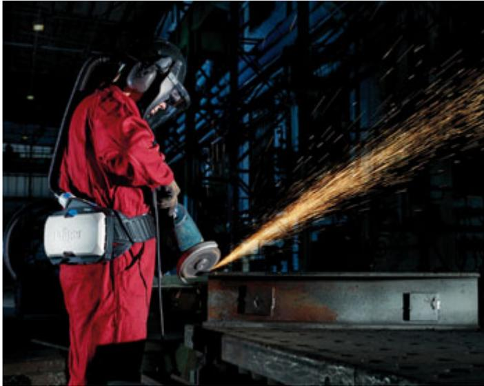
L'appareil respiratoire filtrant à ventilation
