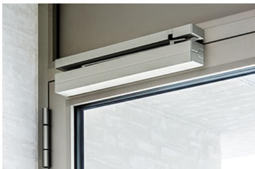
Le ferme-porte mécanique de Effeff équipé de la fonction Close-Motion® garantit une fermeture extrêmement silencieuse et fiable. Dans un premier temps, la porte se referme de manière traditionnelle, puis le système Close-Motion® procure un mouvement de fermeture rapide suivi d'un amortissement souple pour assurer l'occlusion complète et feutrée de la porte, ainsi qu'une parfaite jointure entre le cadre et le vantail.
